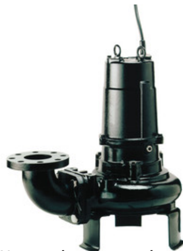
Vortex-juoksupyörä, jossa leveä pumppukotelo, 4-napainen moottori, tukkeutumaton.
