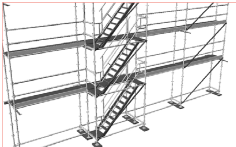
Kuva 2.50 – Ulkopuolinen, yksitasanteinen porrasmousu
