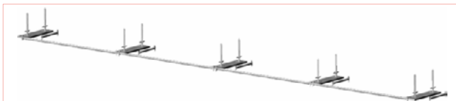
Kuva 2.32a – Vaihe 1 – Säätöjalkojen asentaminen
