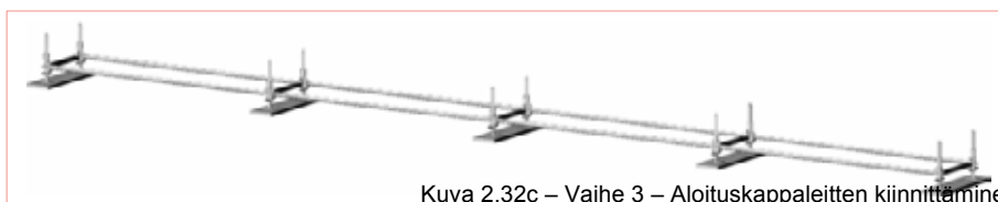
Kuva 2.32c – Vaihe 3 – Aloituskappaleitten kiinnittäminen yhteen
