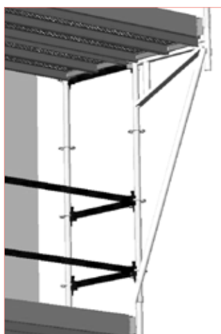
Kuva 2.16 – Tason jatkaminen ulkkeella ja vinojäykisteellä
