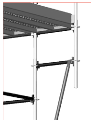
Kuva. 2.17 – Tason jatkaminen välitukien ja vinojäykisteiden avulla
