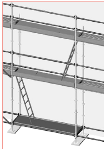
Kuva. 2.23 – luukullisen alumiinitason ja siihen integroitujen alumiinitikkaiden avulla toteutettu nousutie
