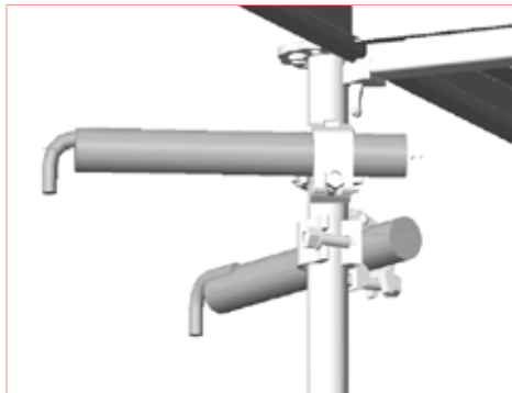
Kuva 2.18b – Telineensisäisten pystyputkien ankkurointi V-ankkurilla
