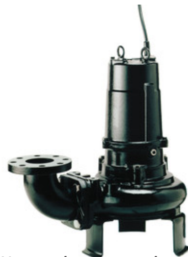
Vortex-juoksupyörä, jossa leveä pumppukotelo, 4-napainen moottori, tukkeutumaton.
