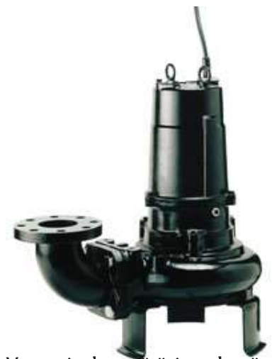
Vortex-juoksupyörä, jossa leveä pumppukotelo, 4-napainen moottori, tukkeutumaton.
