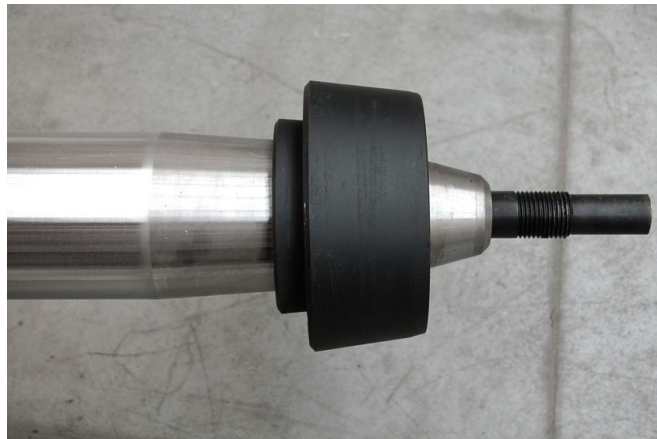
Kuva 4. Työntökartioiden sarja asennettuna runkoon.
